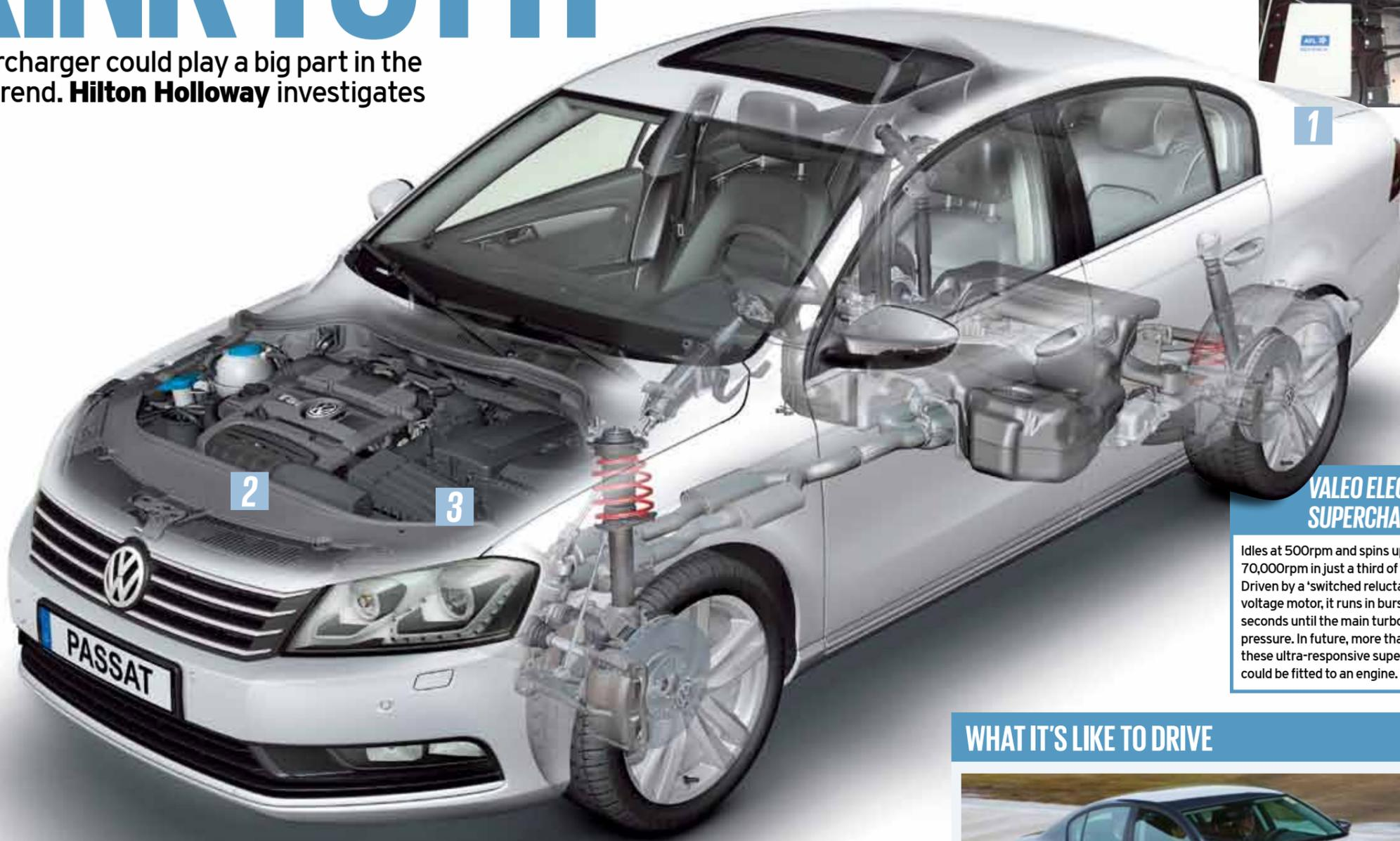
**1 TWIN EXIDE ORBITAL 50AH LEAD-ACID BATTERIES**
